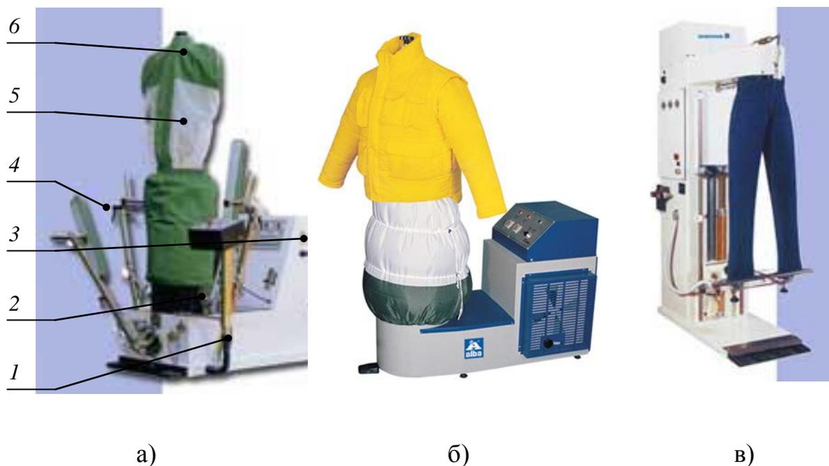
Рис. 2.18. Паровоздушные манекены различного назначения
