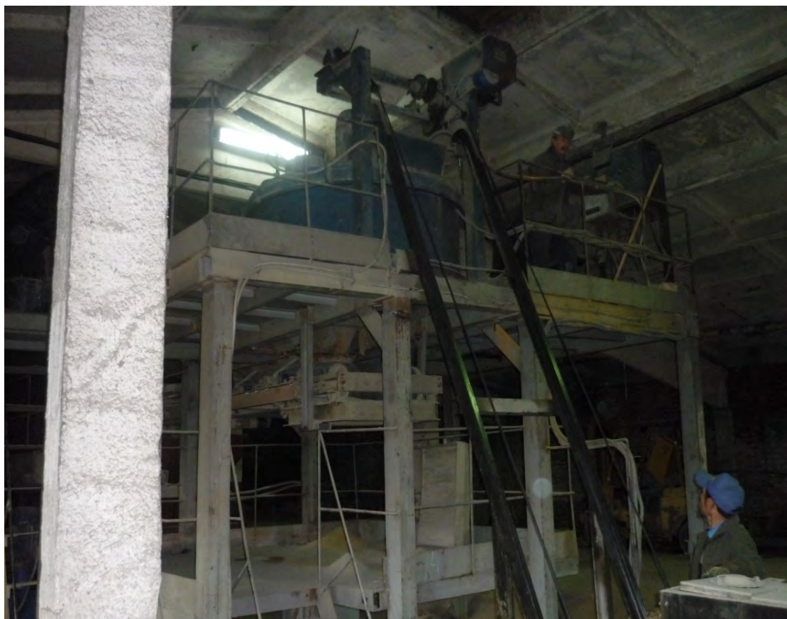
Рисунок 5.5. Подача ОДКП в смеситель при помощи нории
