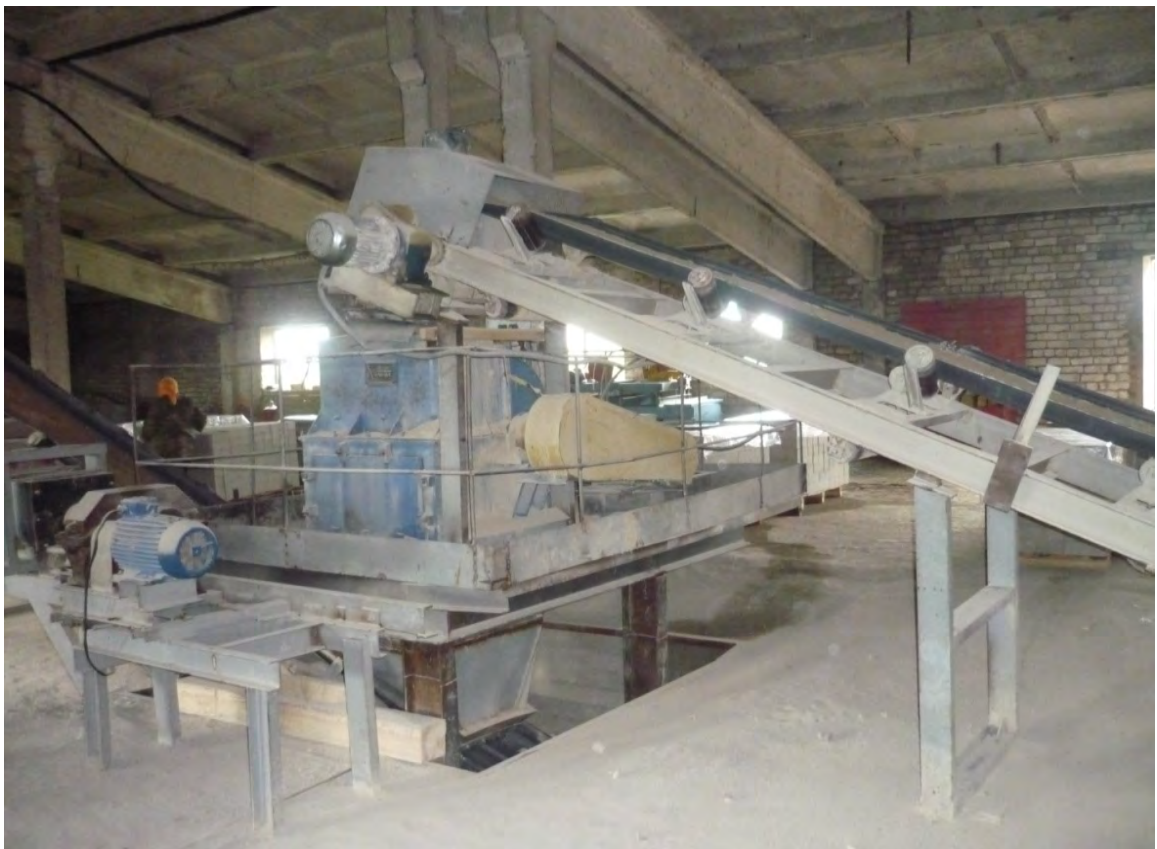
Рисунок 5.3. Молотковая дробилка для измельчения щебня при нехватке ОДКП
