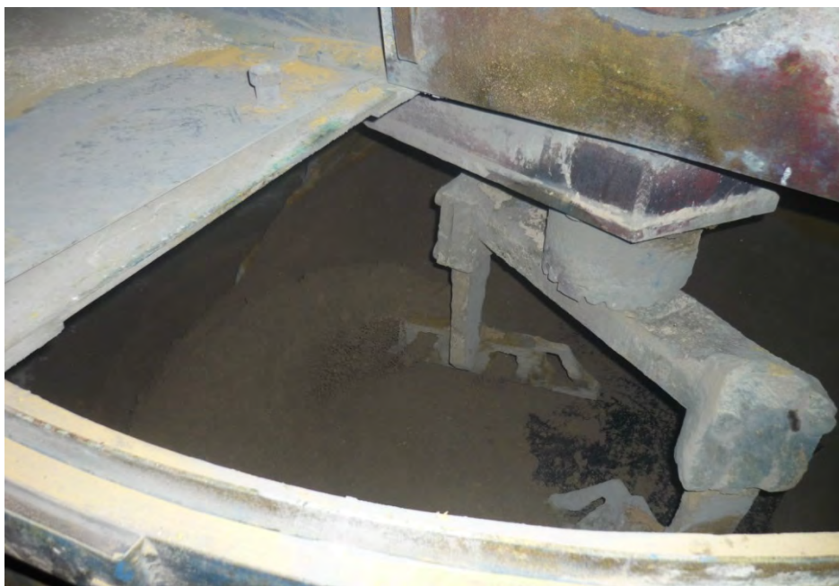
Рисунок 5.6. Процесс перемешивания сырьевых компонентов материала
