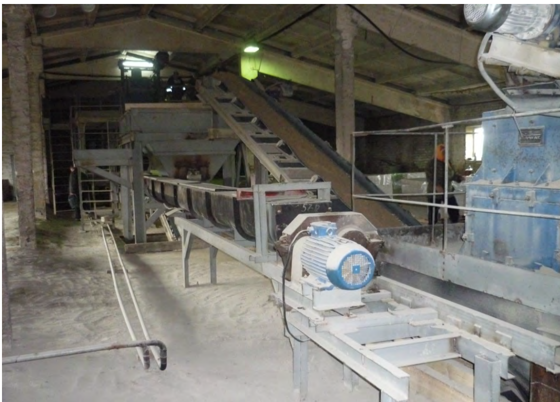
Рисунок 5.4. Транспортировка измельченных ОДКП в расходный бункер
