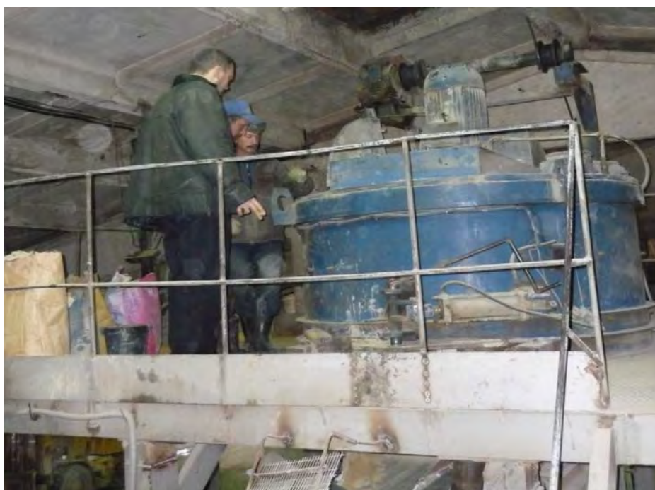
Рисунок 5.7. Приготовление сырьевой смеси в смесителе БС-750/500
