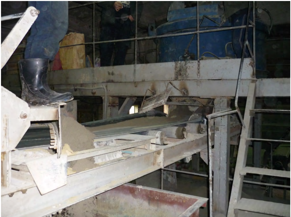
Рисунок 5.9 .Транспортировка смеси из бетоносмесителя в формовочную установку по ленточному конвейеру
