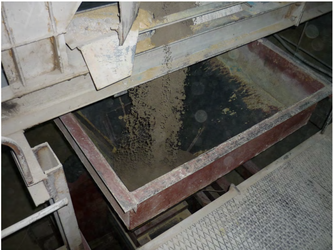
Рисунок 5.10. Подача сырьевой смеси в установку формования АВ 6430
