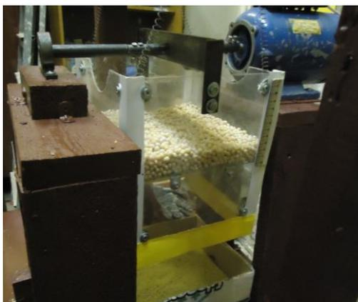
Рисунок 9. Лабораторная установка для периодического грохочения реальных сыпучих материалов
